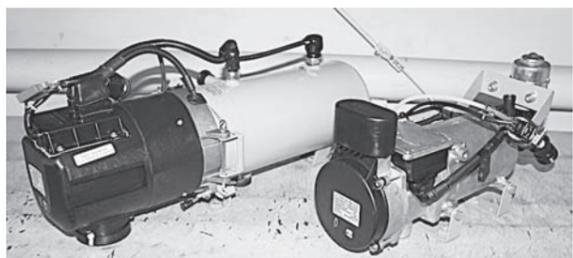
проходят опытные испытания предпускового подогревателя мощностью 5 кВт для легкого коммерческого транспорта – например, для автомобиля «Газель».
