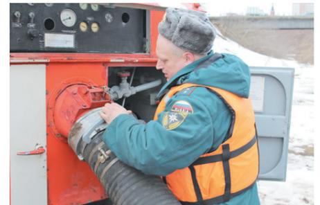
СМИ пожарный расчёт показал возможности спецтехники в действии. Так мы и выяснили: общая длина пожарных рукавов в случае необходимости может составить два километра, и этого расстояния вполне достаточно, чтобы доставить воду к зданию ЦРБ прямо из Волги. А ПНС на базе автомобиля ЗИЛ-131, оснащённая дизельным танковым двигателем (таким же, как и на Т-34), на наших глазах выдала мощную струю воды – 110 литров в секунду.
