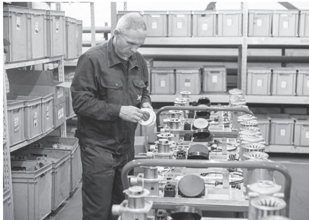
половине цеха собирают жидкостные подогреватели, в другой – воздушные отопители. И те, и другие выпускаются в различных модификациях. По большей части за разницу между продуктами отвечает программное обеспечение электронной части устройств. Печатные платы изготавливаются за пределами предприятия, но по собственным инженерным разработкам. Практика вполне себе нормальная – нельзя заниматься всем подряд.
