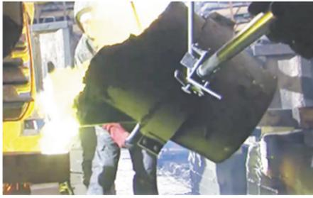
где в настоящее время отливают части памятника для Ржевского мемориала советскому солдату. Слитки бронзы загружают в печь, при температуре около 1200 градусов они плавятся до жидкого состояния, затем расплавленную бронзу заливают в заранее подготовленные формы.
