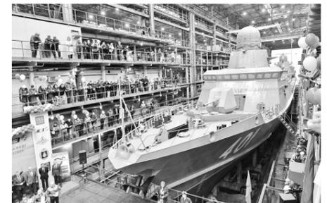
Напомним: малый ракетный корабль проекта 22800 был спроектирован Центральным морским конструкторским бюро «Алмаз», он заметно отличается от аналогов и даже может потягаться с крупными боевыми единицами. Длина корабля – 67 метров, ширина – 11 метров, осадка – 4 метра. Максимальная скорость хода – 30 узлов (около 56 км в час). МРК вооружён 76-мм автоматическим универсальным орудием и зенитным ракетно-пушечным комплексом «Панцирь-М», а также ударным комплексом крылатых ракет «Калибр-НК».
